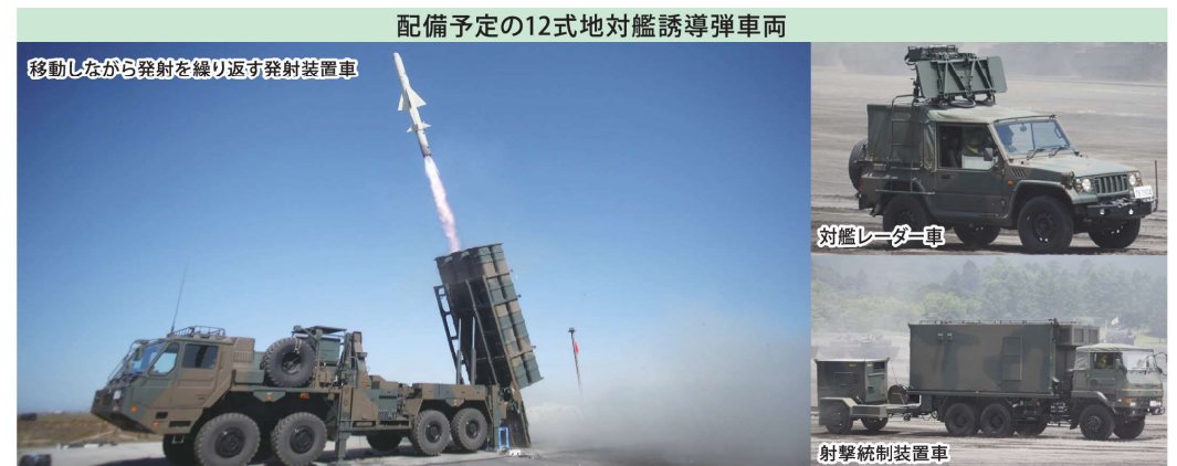
対艦レーダー車、無線中継装置車、指揮統制装置車、射撃統制装置車、発射装置車、運搬装填車等が最大28両配備される
